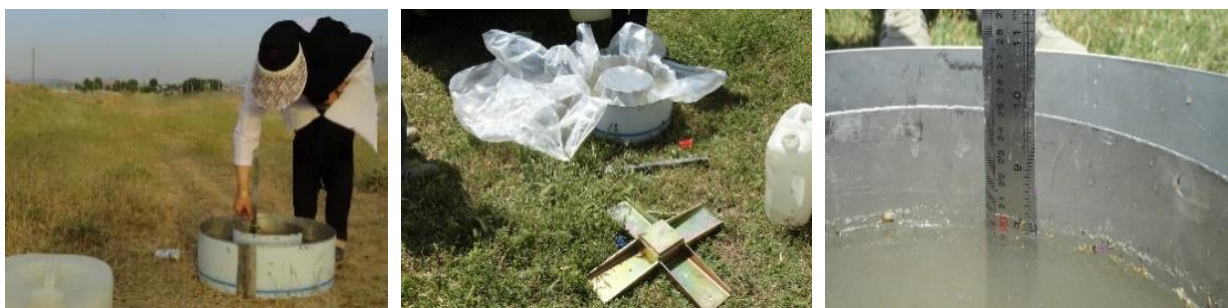
شکل ۳- نمونه برداری صحرایی نفوذپذیری با استفاده از روش استوانه مضاعف Figure 3- Field survey sampling by using double ring method
