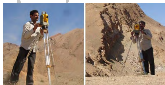
شکل ۴- اندازه گیری میدانی زبری سطح در شبکه ای به ابعاد ۵×۵ متر با نقاطی به فواصل ۳۰ سانتیمتر در محل سایت های انتخاب شده.
