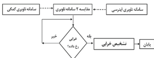
شکل ۳: الگوریتم شناسایی و تشخیص خرابی با استفاده از حس گر نرم
