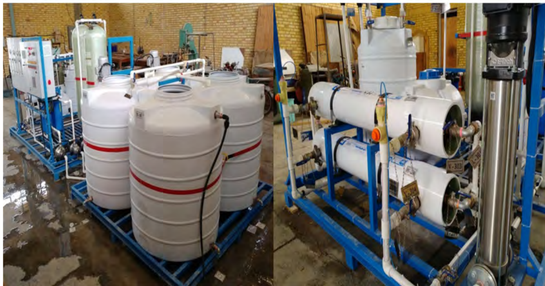
Fig. 2. The HRFO pilot plant at hydraulic lab of Shahid Chamran University of Ahvaz شکل ۲- پایلوت ترکیبی اسمز معکوس مستقیم در آزمایشگاه هیدرولیک دانشگاه شهید چمران اهواز
